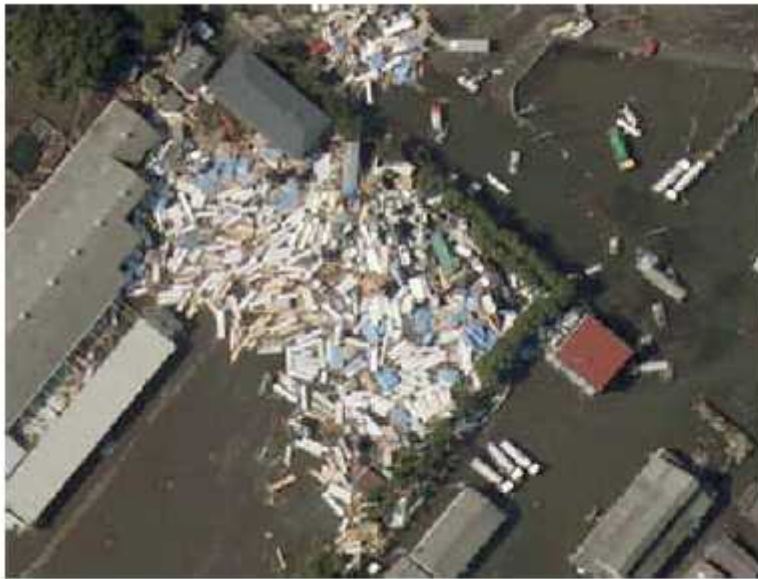
図 I-9 工場の緩衝緑地が漂流物を捕捉（多賀城市） 出典：国土地理院 空中写真（平成 23 年 3 月）より作成
