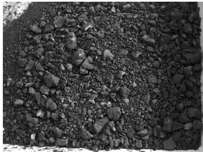
路面切削機で削り取られたアスファルト塊 (細粒分が多く、排水性舗装に適さない骨材粒度になっている。)
