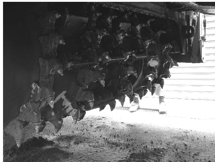
路面切削機の回転ドラムとビット
