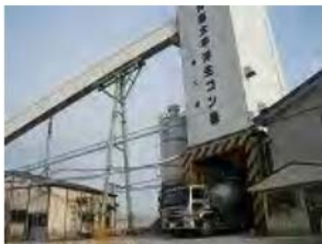
生コン工場にシェルサンドを搬入し、シェルコンクリートを製造する
