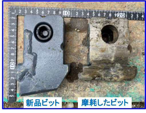
硬質岩によりビットが損耗し掘削難航
