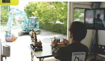
簡易遠隔操縦装置[ロボQS]ユニットが小型軽量のため、容易に運搬が可能
