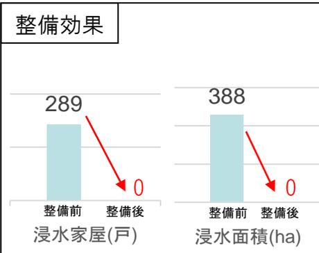
河道掘削等によって、JR橋梁架替事業と合わせて河積を拡大し、計画規模の洪水に対して浸水被害を解消できる。
