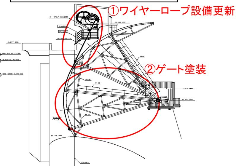
クレストゲート設備の老朽化状況
