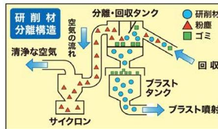
素地調整における研削材の回収・再利用によりコスト縮減および産業廃棄物縮減
