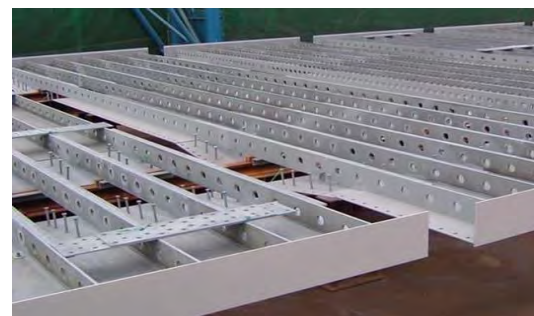
写真-7 鋼コンクリート合成床版
