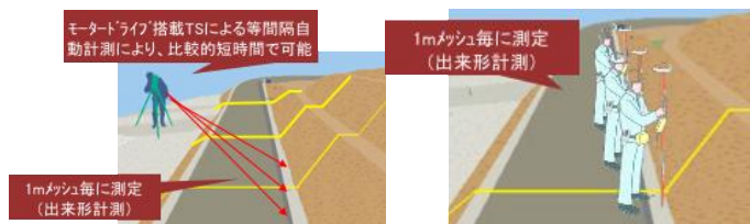
図-9 TS(ノンプリズム方式)での計測方法(左)、RTK-GNSSでの計測方法(右)
