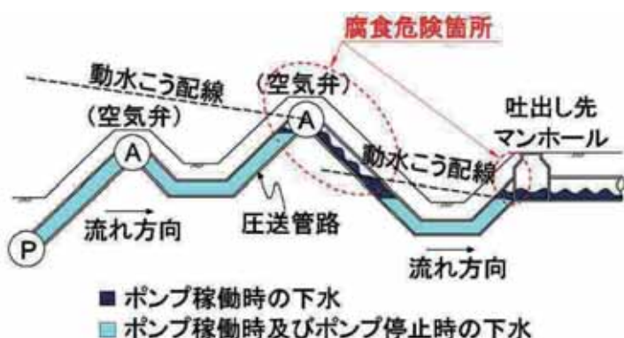
【腐食危険箇所の絞り込み手法】
