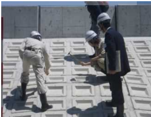
打音による空洞調査
