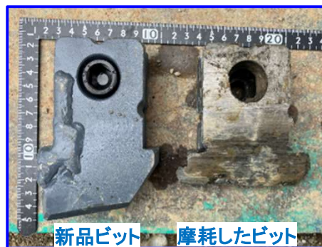
安指川橋P1施工箇所で硬質岩が出現
