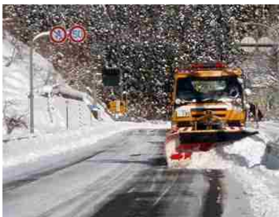
除雪トラックによる除雪(前から)
