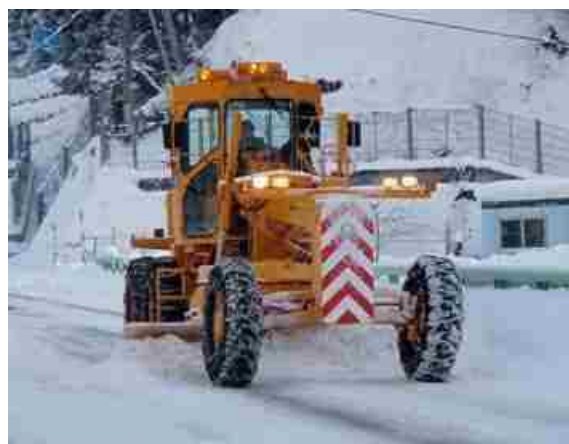
除雪グレーダーによる除雪(前から)
