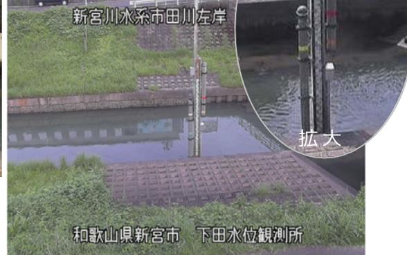
夜間でも視認できるように反射素材のカラーテープを使用し、費用をかけずに、簡易に設置可能です。
