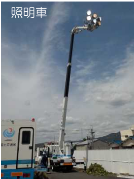
災害現場で夜間時に作業をする際の灯りを確保。照明の他、カメラにより動画の撮影、送信もできる（設営訓練と動画送信を実施）
