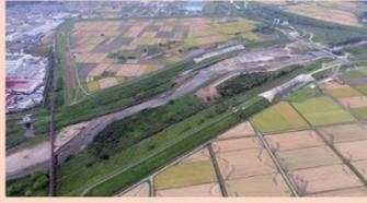
2年前（平成27年）の6月に運用を開始してから、先月10月22～23日の台風21号ではじめて4つの遊水地で洪水（川からあふれた水）約600万立方メートルを貯留しました。洪水を貯留したことによって上野地区160ha、約760戸の浸水を防ぎました（推計）。
