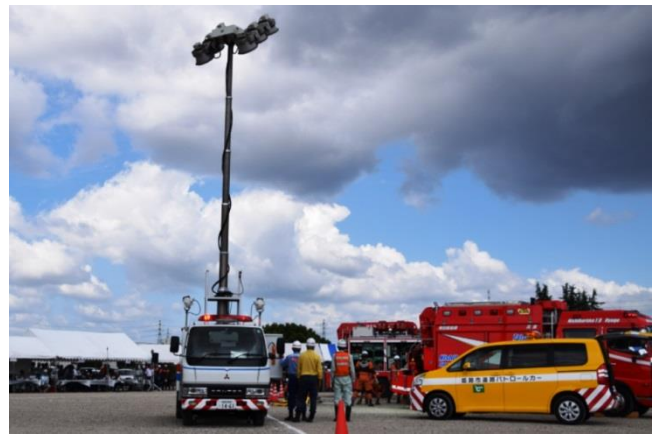
道路啓開訓練を支援する事務所照明車
