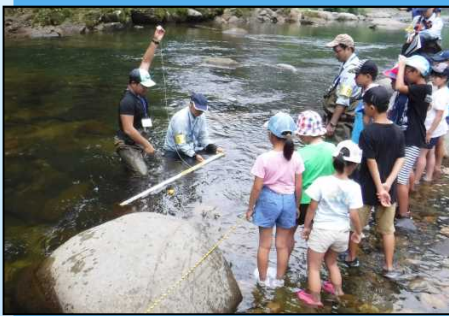
【ピンポン球で流速を測定】
