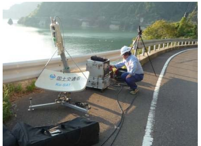
Ku-SATで斜面崩落箇所を常時観測(福井県若狭町遊子地先)
