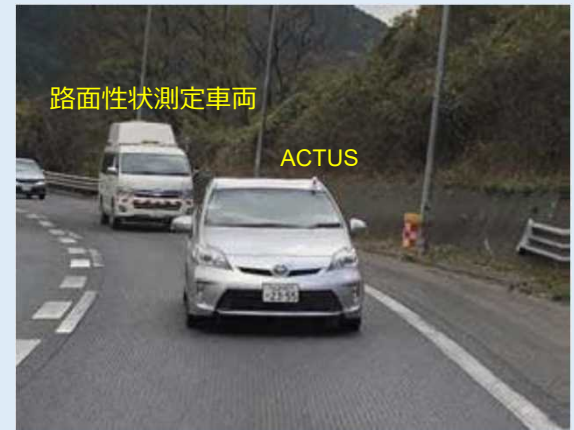
ACTUS計測状況 路面凹凸情報の記録 計測状況 (ACTUS + 路面性状車)
