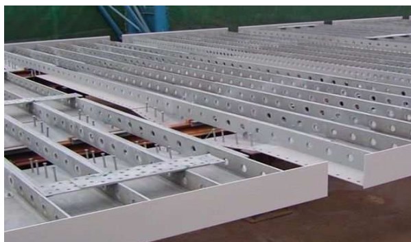
写真-7.1 鋼コンクリート合成床版
