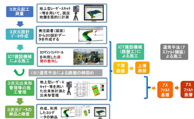
図-7.5 ICT 舗装工の流れ
