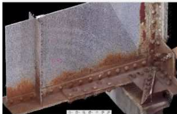
図-7.11 点群データからの外形線作成
