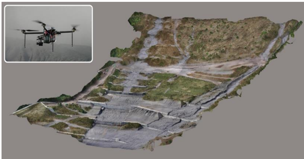
図- 1 SfM で作成した三次元地形情報（雲仙・普賢岳の水無川の事例）
