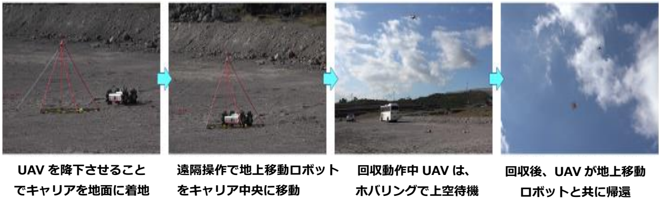
図-3 UAVによる地上移動ロボットの回収実験の様子
