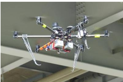
写真-4 橋梁維持管理用ロボット
