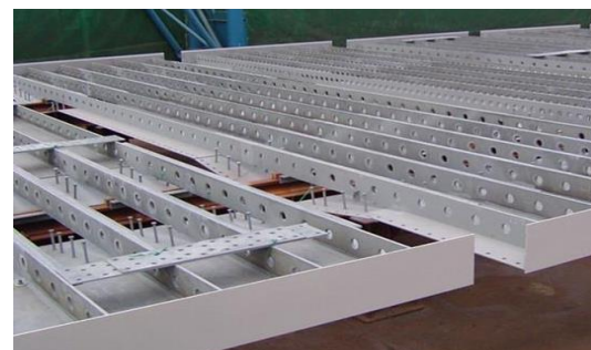
写真-7 鋼コンクリート合成床版
