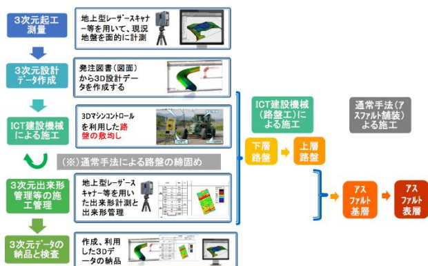
図-7 ICT 舗装工の流れ
