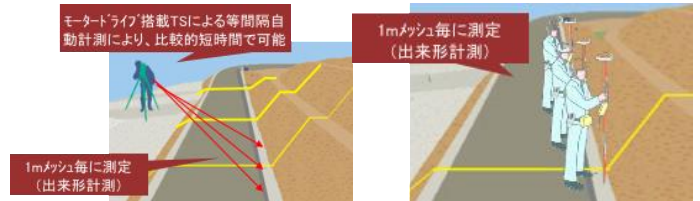
図-9 TS(ノンプリズム方式)での計測方法(左)、RTK-GNSSでの計測方法(右)
