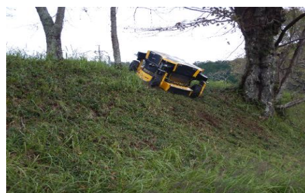
写真-8 Spider (無線遠隔操作斜面对応フリーグラスチョッパー)
