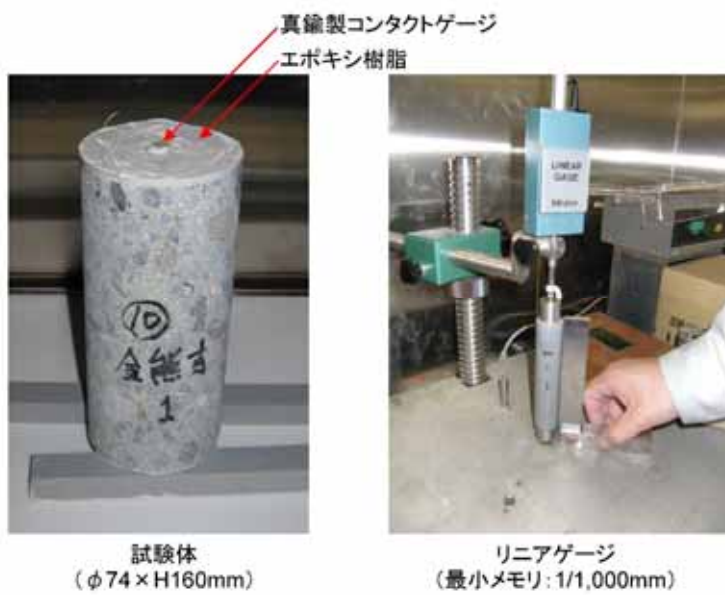
写真4 - 26 . 試験体とゲージ
