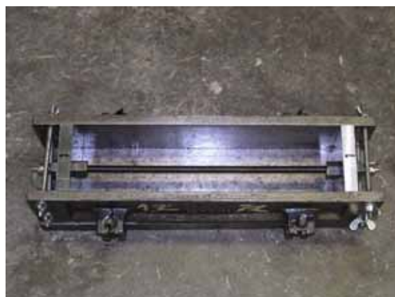
写真4 - 28 . 拘束器具の型枠セット状況 (JIS A 6202 附属書 2 B法)
