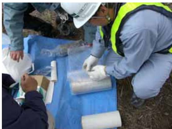
写真4 - 24 . 緩衝材による梱包 搬送
