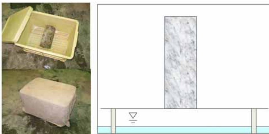
写真4 - 10 . コンタクトゲージ取付け中の試験体の保管方法
