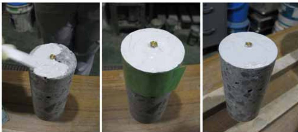
写真4 - 9 . コンタクトゲージの取付け(その2)
