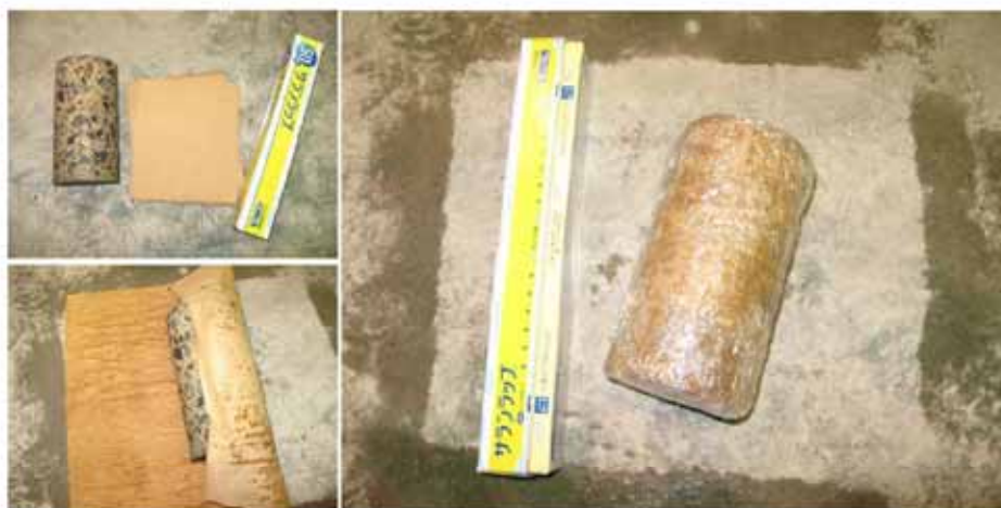
写真4 - 7 . コア採取後の保管方法
