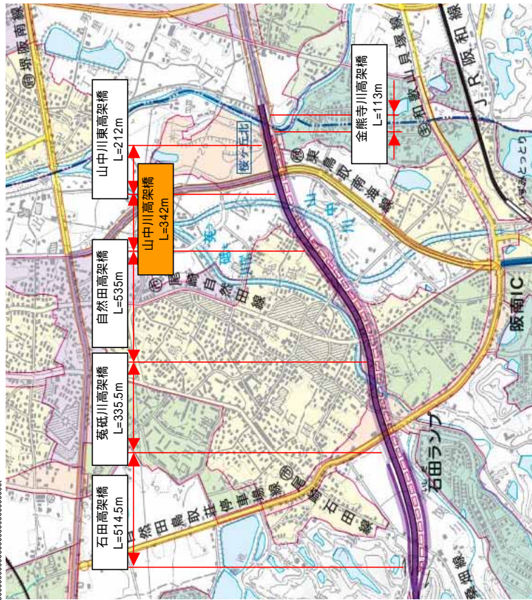
図3 - 11 . 山中川高架橋 架橋位置
