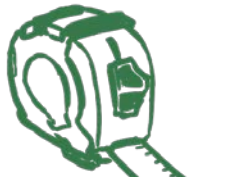
コンベックス 亀裂の幅や段差を計測
