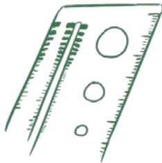
クラックスケール 亀裂の幅を正確に計測
