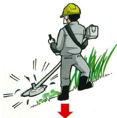
図 1.15 傾斜地での作業姿勢
