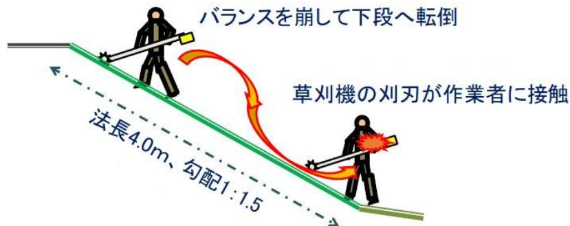
図 2.4 上段作業者の転倒による下段作業者への接触事故例 (参考図)
