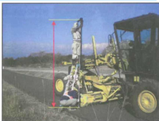
全周プリズム中心からブレード下端の測定状況
