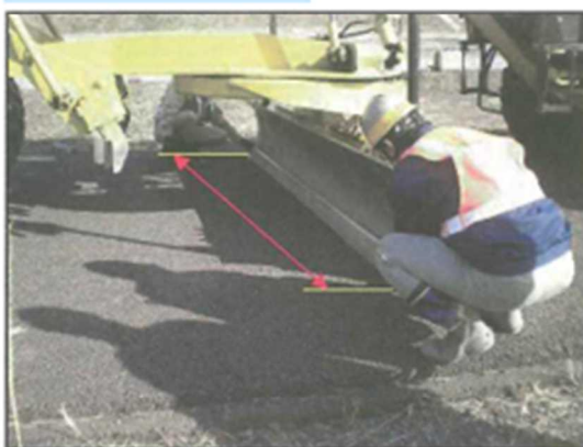
ブレード幅の測定状況
