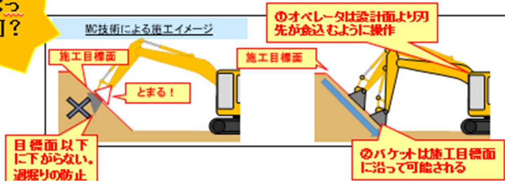
MC(バックホウ)技術を用いた施工イメージ
