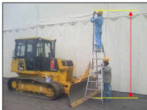
全周プリズム中心から排土板下端の測定状況
