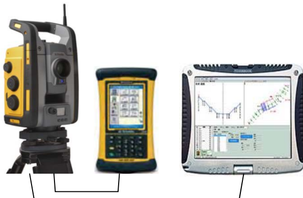
【TSと専用のデータコレクタやPCを接続するタイプ】
