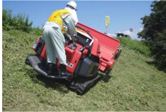
写真 1.11 急傾斜地での斜め走行（上り）
