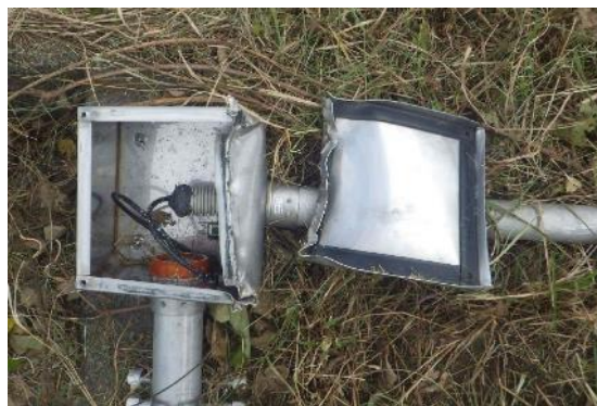
写真 2.6 ケーブルボックスの破損事故現場の状況（参考写真）
