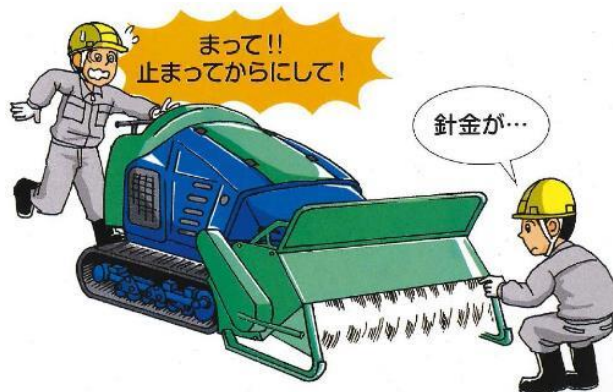
図 1.24 異物巻き込み時の注意
