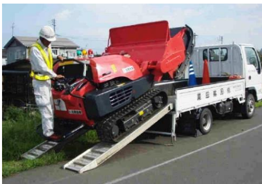
写真 1.4 草刈機の搬入と荷台への積載状態
