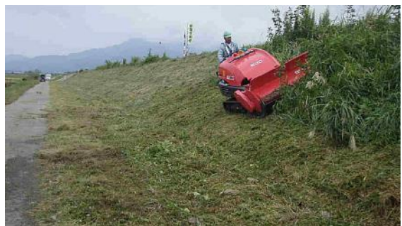
写真 1.10 住宅地との隣接や傾斜角度の変化は順路を調整
