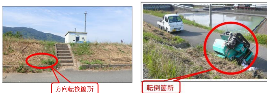
写真 2.5 小段の集草作業中の転倒事故（参考写真）
