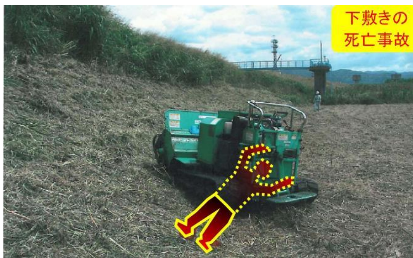
写真 2.2 運転者が草刈機の下敷きとなった事故状況（参考写真）
