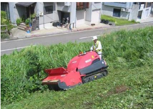
写真 1.10 住宅地との隣接や傾斜角度の変化は順路を調整
