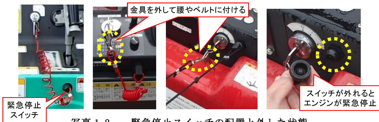
写真 1.2 緊急停止スイッチの配置と外した状態
