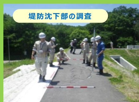
打音による空洞調査
