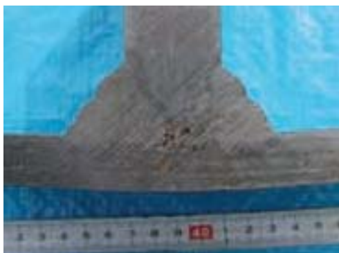
溶け込み不良を再現した試験片
