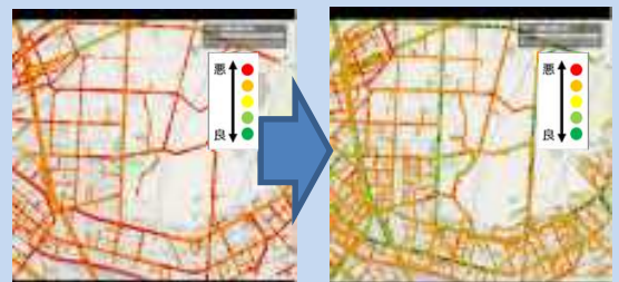
『圧雪路面の凸凹状況 (左: 除雪前 右: 除雪後)』
