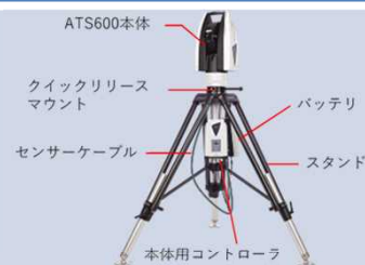
レーザートラッカーの構成
