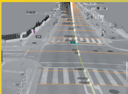
3次元起工測量
