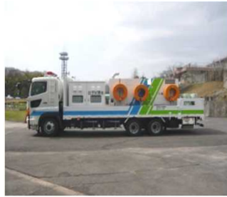
排水ポンプ車
