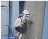
削孔作業と粉体採取
