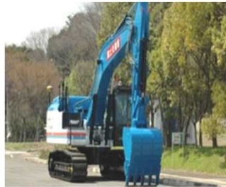
分解対応型バックホウ (無人化施工)
