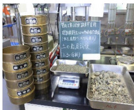
土の粒度試験状況
