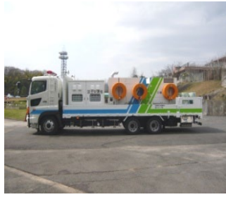
排水ポンプ車
