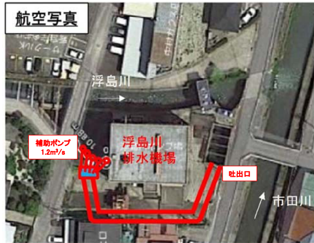
図-2.3 浮島川排水機場補助ポンプ整備
