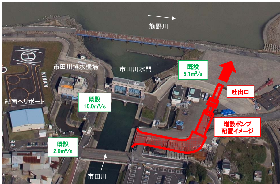
図-2.2 市田川排水機場ポンプ増強
