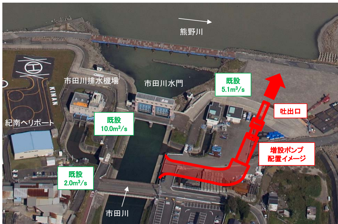
市田川排水機場ポンプ増強
