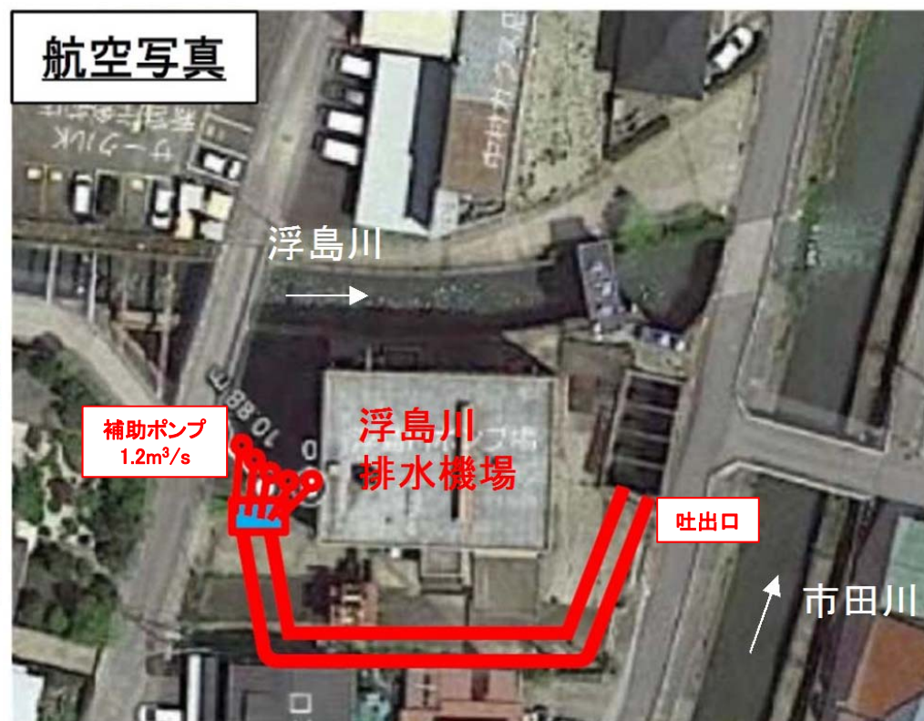
浮島川排水機場補助ポンプ整備
