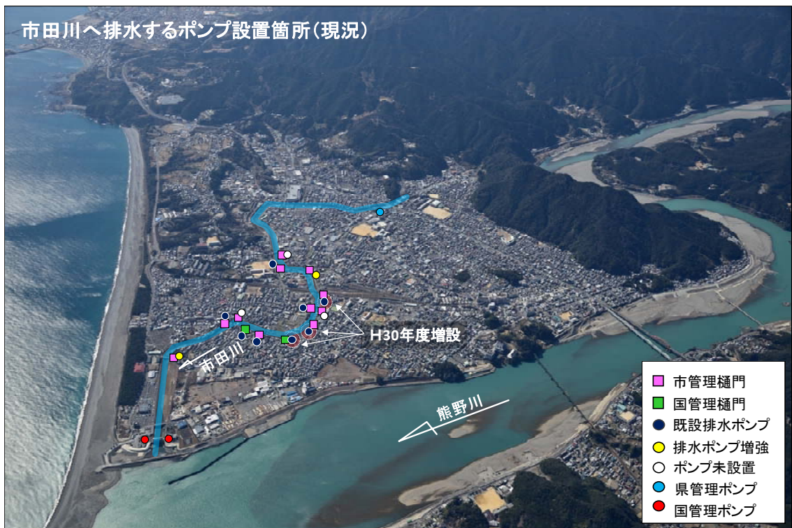
図－2.4 市田川へ排水するポンプ設置箇所（現況）
