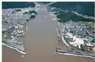
洪水時 H26.08.11 撮影 相賀最大水位 I.P.16.59m (推定流量: 10,200m 3 /s)
