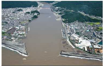
洪水時 H26.08.11 撮影 相賀最大水位 T.P.16.59m (推定流量: 10,200m 3 /s)
