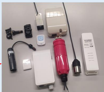
実証実験に用いている浸水センサ
