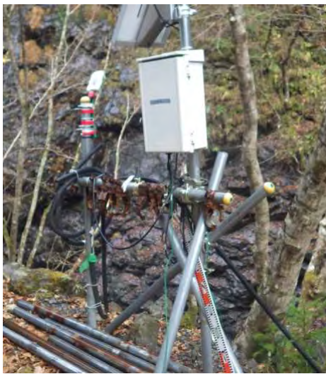
水圧式水位計による観測状況（赤谷地区）
