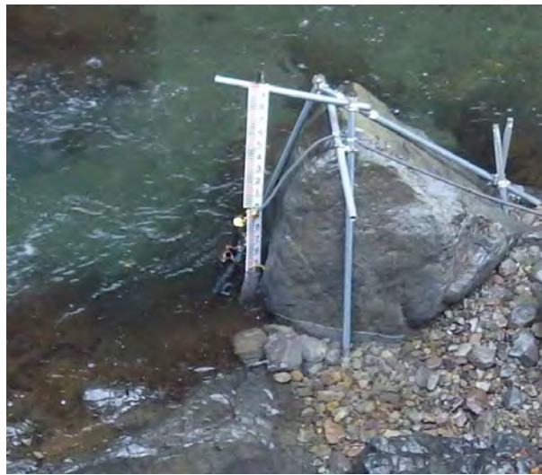
水圧式水位計による観測状況（赤谷地区）
