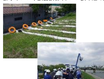
排水ポンプ車設営訓練（ポンプ投げ込み）
