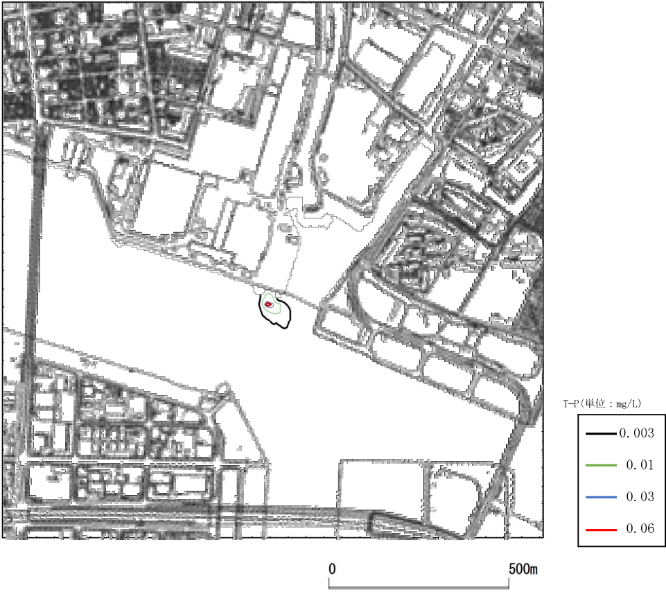
図4. 3. 2-19 (11) 夏季T-P寄与濃度分布図（西宮浜北側碎石投入、中層）
