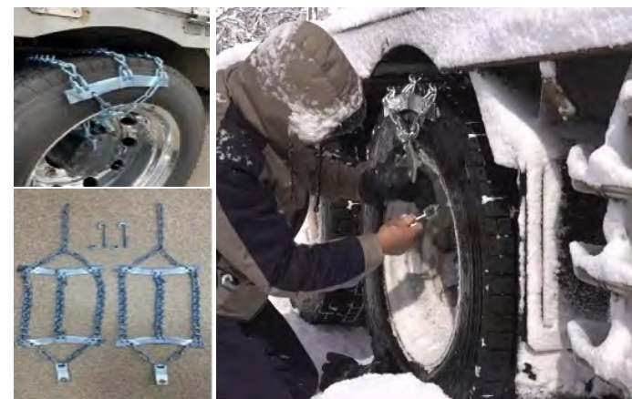
緊急脱出用チェーンによる救助
