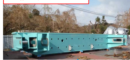
修理用ゲート
